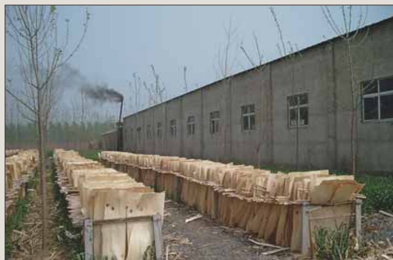
Сушка. Типичная китайская фанерная компания покупает высушенные листы шпона у небольших производителей, вместо того чтобы производить шпон самой. Фото говорит об устаревшей технологии сушки шпона
