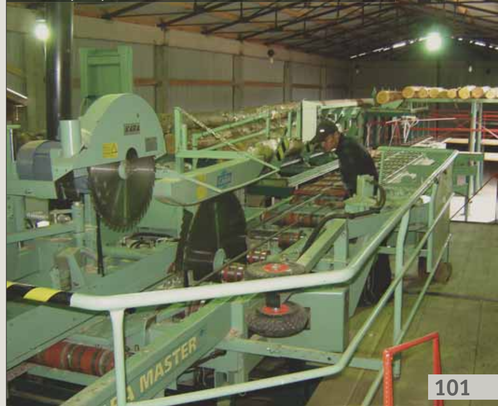
Бревнопильный станок KARA-Master с верхним пильным диском и однооператорным оснащением
