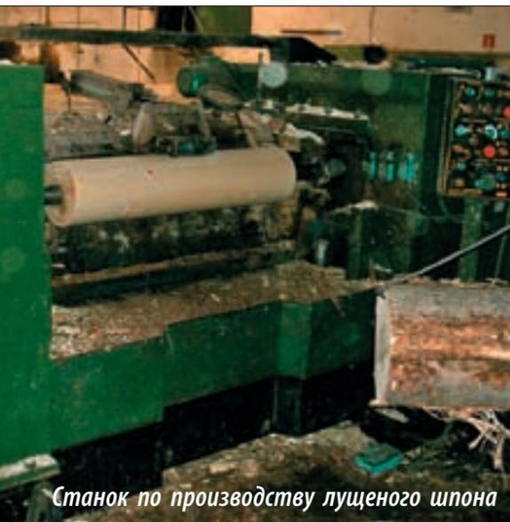
Станок по производству лущеного шпона
