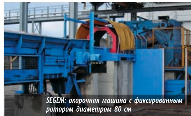
**SEGEM:** окорочная машина с фиксированным ротором диаметром 80 см
