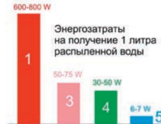
На диаграмме приведены энергозатраты на распыление 1 литра воды в системах увлажнения различного типа:
