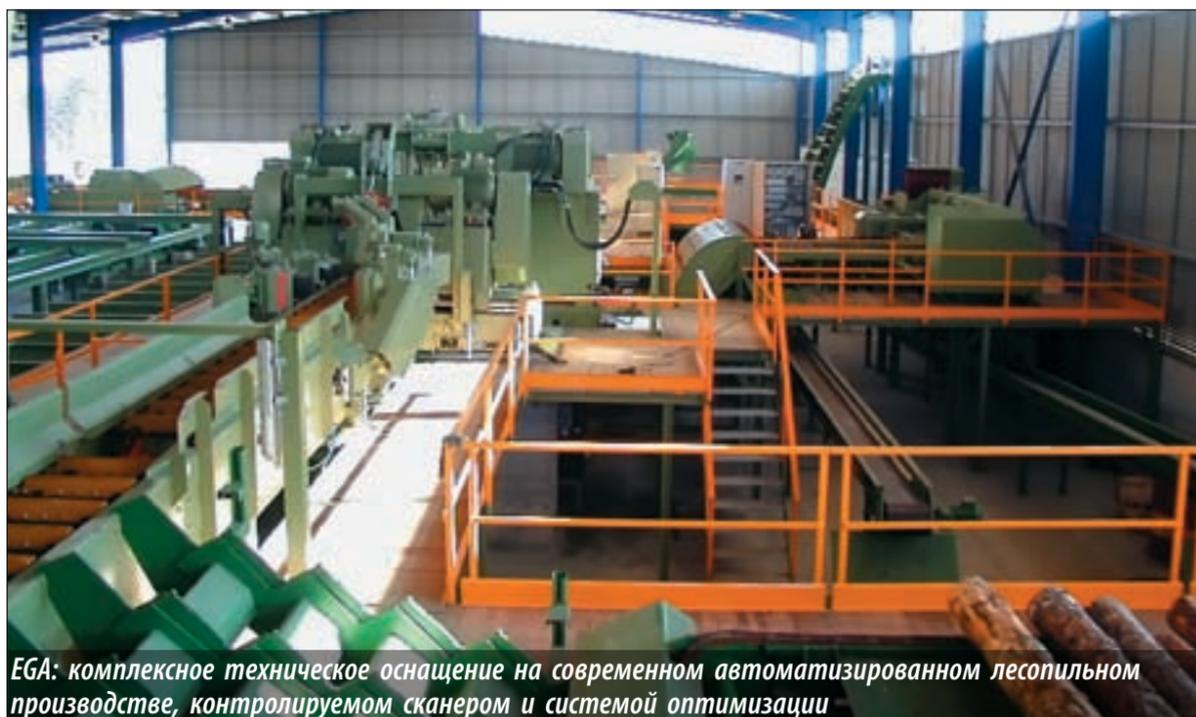
**EGA:** комплексное техническое оснащение на современном автоматизированном лесопильном производстве, контролируемом сканером и системой оптимизации
