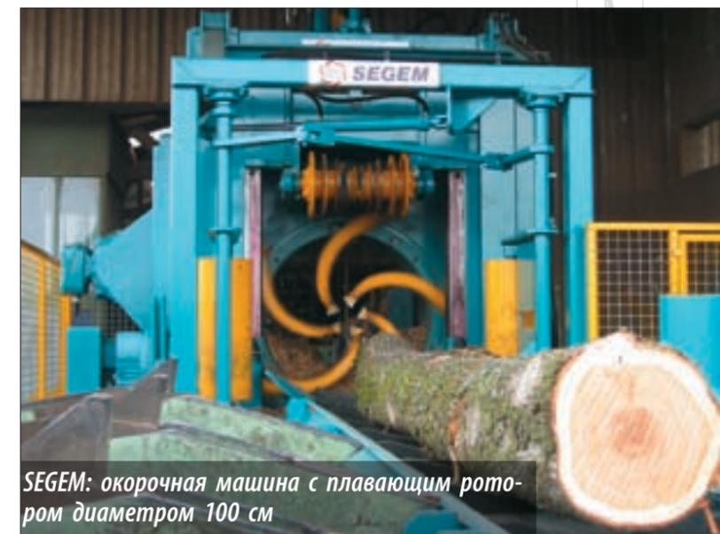
**SEGEM:** окорочная машина с плавающим ротором диаметром 100 см
